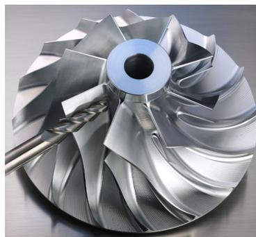
Типичным примером фрезерования закрытых углов является обработка импеллеров.
