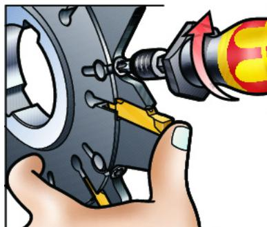
Во фрезе CoroMill 329 для надежного и безопасного закрепления пластины применяется крепление винтом. Поместите большой палец на пластину и нажатием поместите пластину в посадочное гнездо. Используйте отвертку (Torx Plus) для закрепления (раскрепления) пластины.
