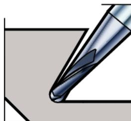
Для финишной обработки радиуса рекомендуется использование конической фрезы со сферическим концом.
