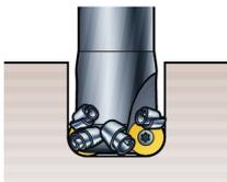
Характерно при обработке пазов и карманов - особенно в титане, а также при фрезеровании глубоких выборок на вертикальных фрезерных станках.
