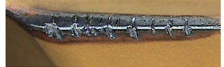
Термотрещины на режущей кромке
