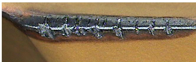
Термические трещины, образующиеся при использовании СОЖ
